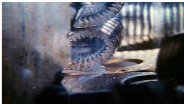
Типичное стружкообразование — съёмка высокоскоростной камерой
